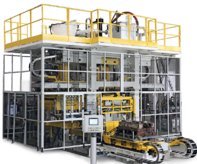
Стержневая машина с применением неорганических связующих
