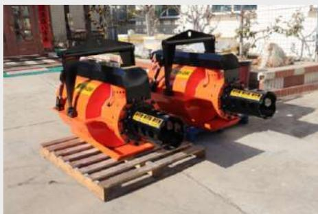
Компания AISENO (Китай) производит пневматические молотки, предназначенные для отделения (отбивки) литников, прибылей и других частей литниковой системы.
